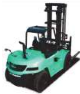
Ανυψωτική ικανότητα >10.000 kg (Συνήθως κινητήρας Diesel)
